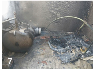
Figuras 3-8. Localización de fugas de gas 3, 6, 7 y 8. Contenedores de gas LP que presentaron fuga y afectaron viviendas. 4 y 5. Personal de bomberos buscando el origen de la fuga de gas y nubes de dípteros psicódidos como ayuda extra para agilizar el control de fugas.
